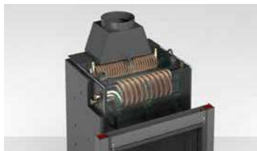
4) Scambiatore FULL LINK tipo S3 per termocamino a vaso aperto con produzione ACS integrata e collegamento ad impianti a vaso chiuso dotati di generatore ausiliario
